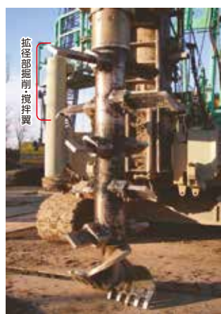
拡径部掘削・攪拌翼
