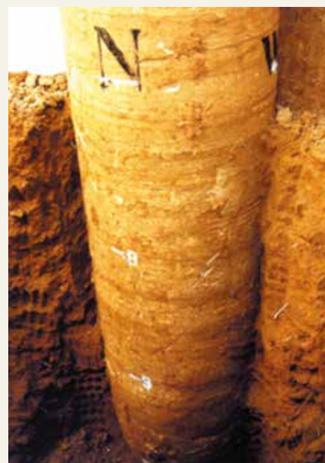
土槽載荷試験後のハイエスシー杭工法
