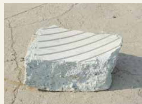
杭体ソイルセメント（深度20mより掘出し）
