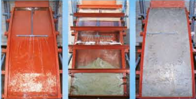
中間位置より15ℓ/分の水を注水し、下部には溜水。上部は蓋の合わせ面より漏水という状態で、エアバックを下部注水孔より注入しました。 注入したエアバックは、水中下で徐々に固結し、だれ現象もほとんど発生していません。 水に稀釈されずに固結しており、注水している水中下でもほとんどエアは流出しなかったことが確認できました。
