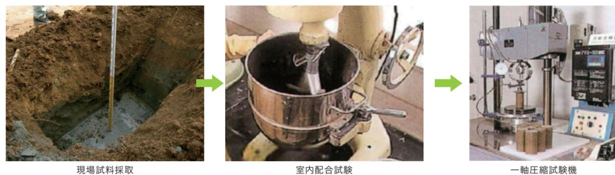
施工後：【強度確認試験】現場で打設した改良体より、供試体を採取し、一軸圧縮試験でその品質の確認を行います。
