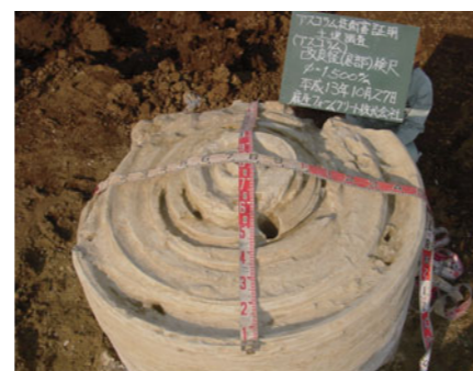
掘起し先端部
